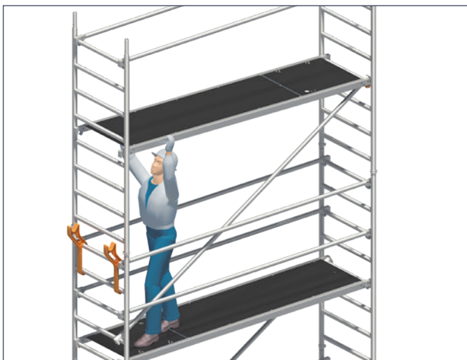
3. Diagonalen und Durchstiegsbrücke einsetzen.
