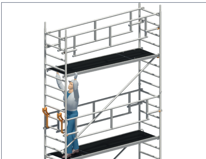
3. Diagonalen und Durchstiegsbrücke einsetzen.
